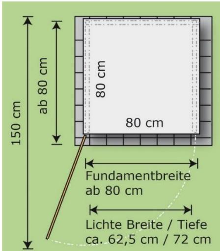
Mögliche Höhen sind 158 oder 120 cm. Mit Hilfe des Dachbegrünungsmoduls (+12 cm Höhe) erhält man ein praktisches **Hochbeet**.
