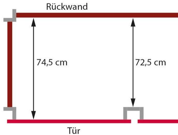
*Aufsicht/Lichte Tiefe Various-2, -3. Bei der Variante mit wegklappbarem Mittelposten, benötigt man noch ca. 18 cm zum Umlegen des Verankerungshebels in der Mitte des Türanschlages. Der Hebel ist weiter oben angebracht. Bei Bedarf können wir die genaue Position mitteilen.*
