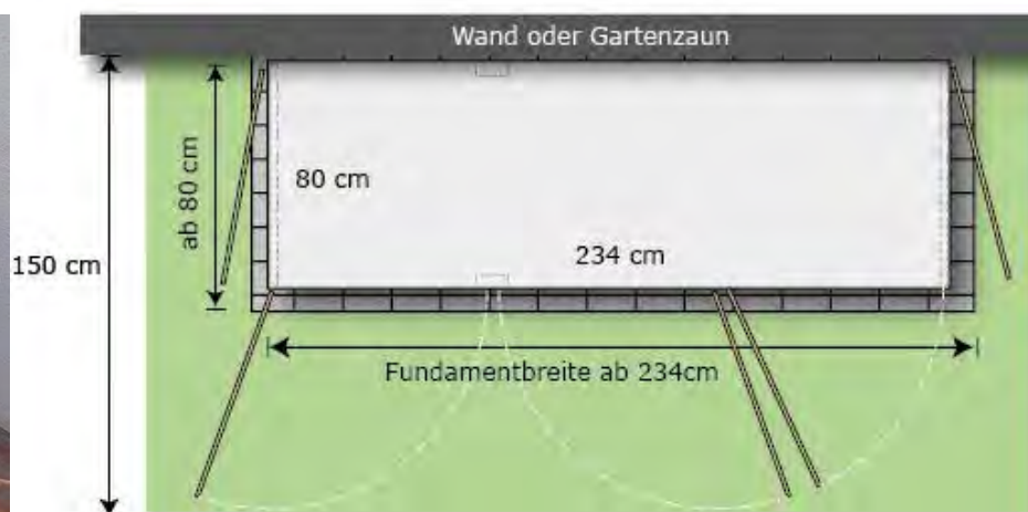
Trash-3 Rückseite geschlossen, optional Türen an den Seiten mit Einwurf für Müllsäcke
